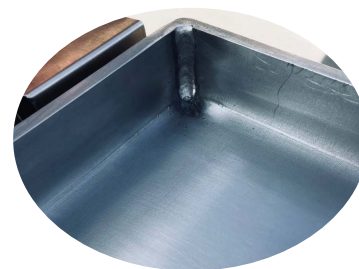
* Soldadura lisa, evita contaminación.
